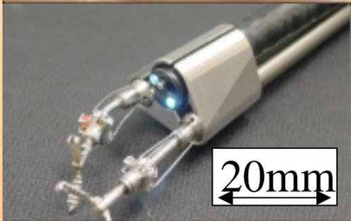
内視鏡ロボット先端の外観図
