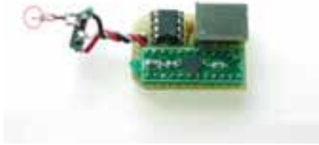
クイック水素ガス検知センサー (最先端部 0.1秒以内で水素漏れを検知)
