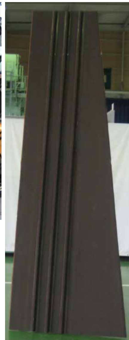
MRJ尾翼(5.5m×1.5m)のカットサンプル (3m×1m) 補足2
