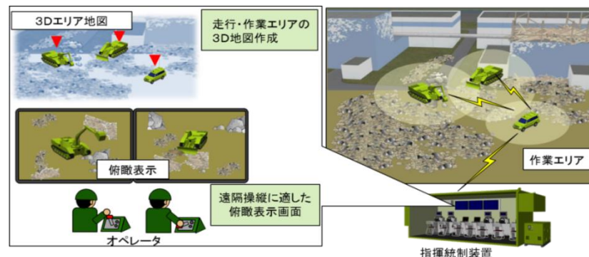
複数車両等の情報統合による環境認識向上技術の研究（イメージ）
