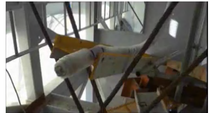
(福島第一原発1号機用試作) 能動スコープカメラ[田所・昆陽2006]
