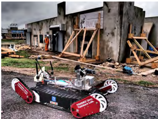
(米国Disaster City) 災害対応ロボットクインス[田所・小柳2011]
