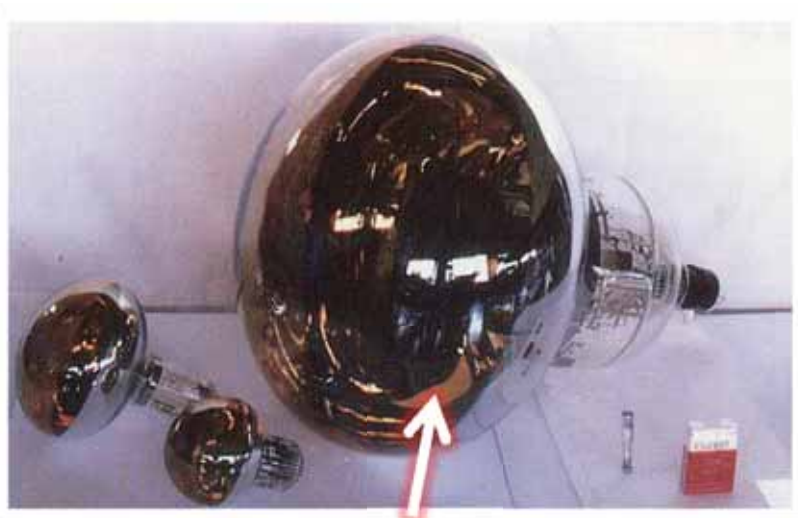
ニュートリノ実験で使われている世界最大の光電子増倍管(光検出器)。現在も改良中。
