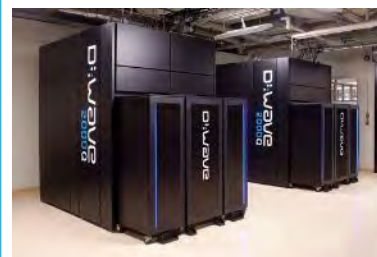
D-Wave社(カナダ)が開発した量子アニーリングマシン（出典：D-Wave社）
