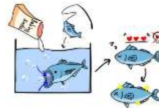
重曹による魚体運動抑制システム(SafiBOX)の模式図
