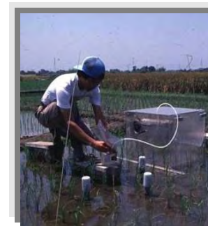
メタン発生測定の様子
