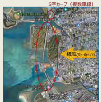
アップダウン + 横風、S字カーブ等での車線維持制御
