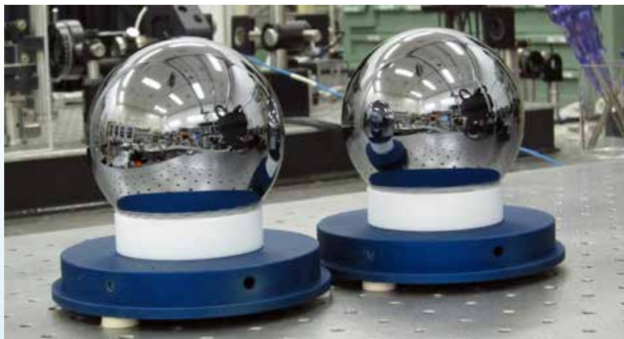
産総研がプランク定数測定に用いたシリコン球
