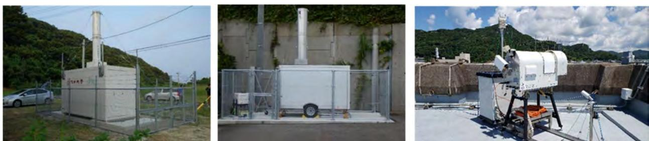
図1 下甑島に設置した水蒸気ライダー（左）、野母崎に設置した水蒸気ライダー（中）、天草市に設置したマイクロ波放射計（右）。
