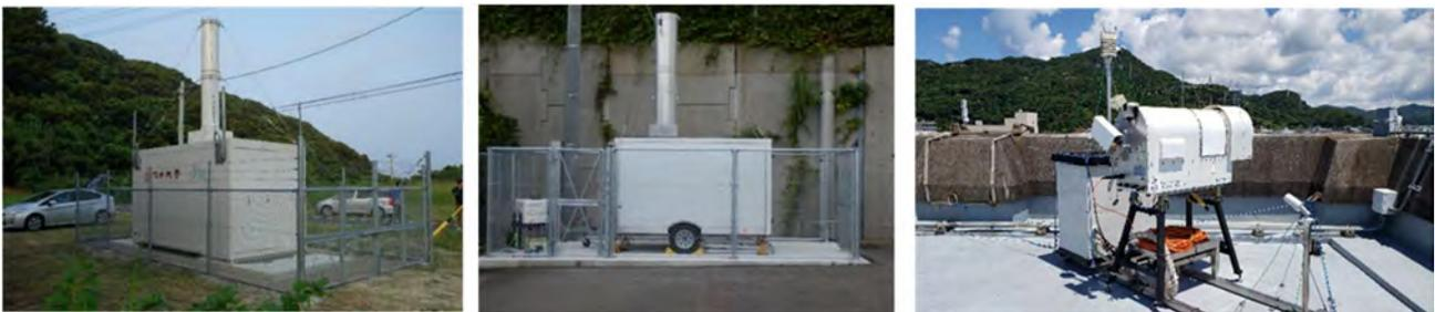
図 1 下甌島に設置した水蒸気ライダー(左)、野母崎に設置した水蒸気ライダー(中)、天草市に設置したマイクロ波放射計(右)。
