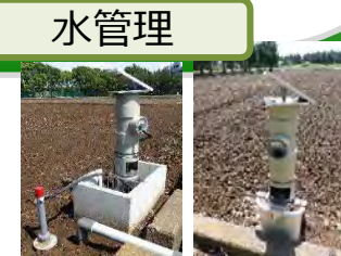
自動・遠隔水管理システム
