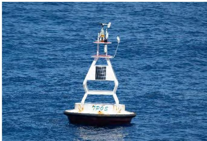
図3-11 JAMSTECが運用休止した、赤道-156Eサイト付近に設置された中国ブイ
