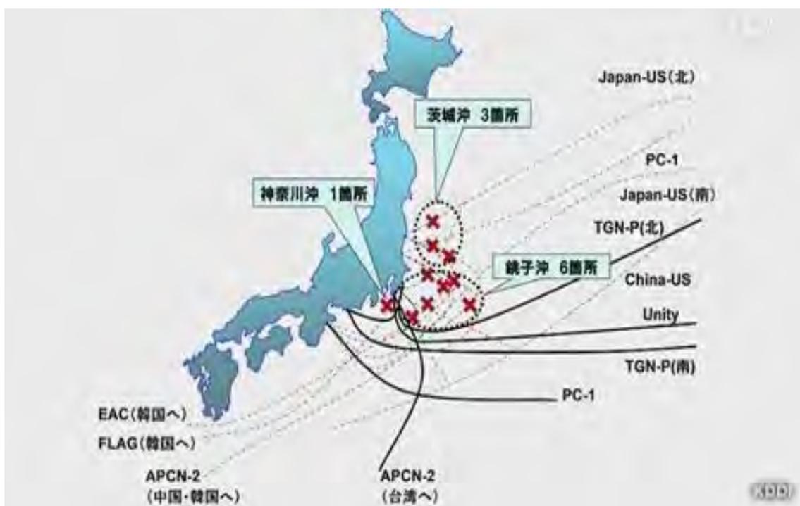
図2-2 東北地方太平洋沖地震の際の海底ケーブルの障害<sup>18</sup>
