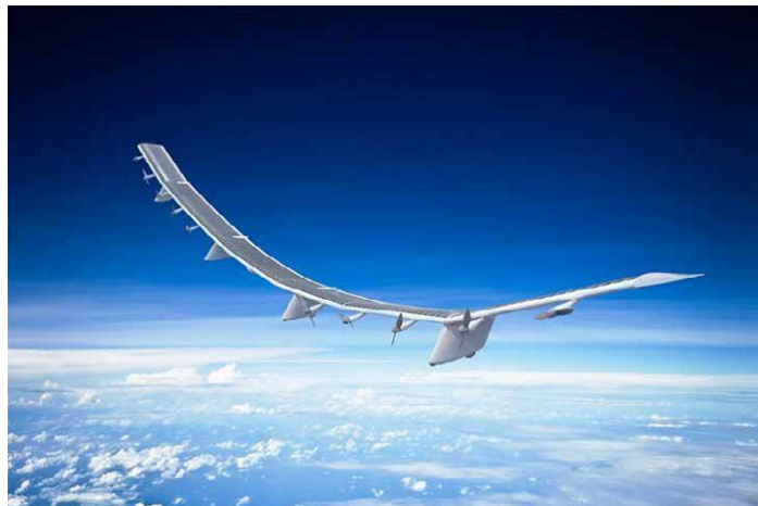
図2-1 成層圏通信プラットフォーム向け無人航空機「HAWK30（ホーク30）」 (出典：参考文献3)
