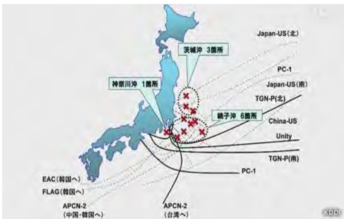
図2-2 東北地方太平洋沖地震の際の海底ケーブルの障害 18
