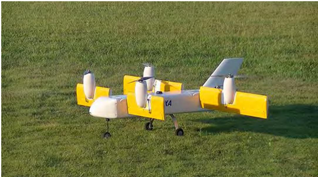
図4-7 4 発ティルト翼 VTOL 小型技術実証機 (McART3)
