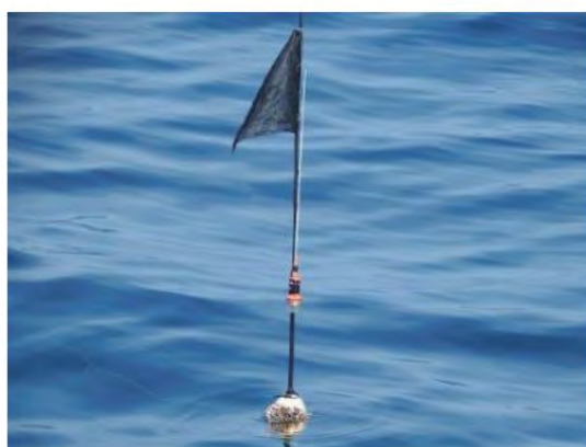
図 3-24 漁具に設置された AIS
