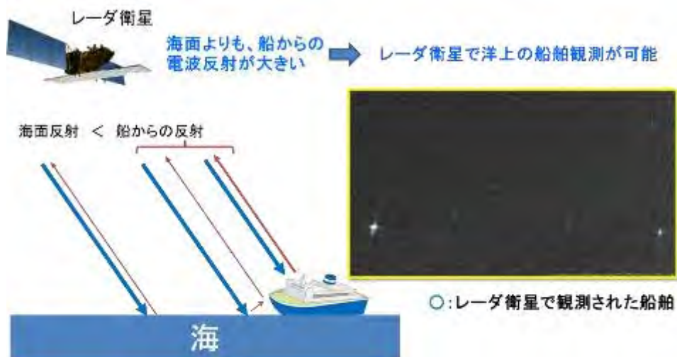
図 3-25 合成開口レーダ (SAR) 衛星による船舶の観測原理
