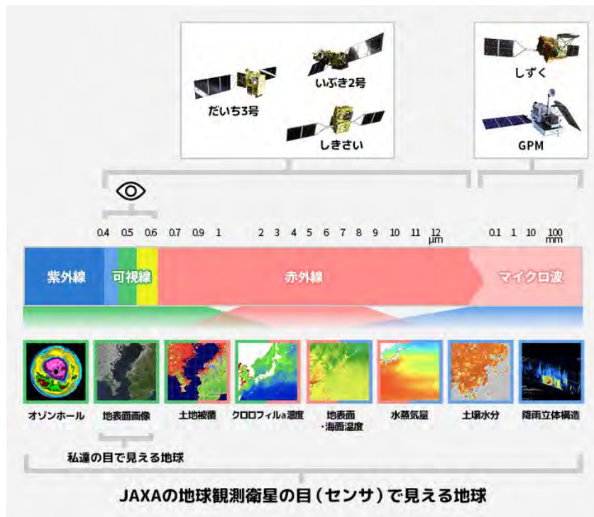
(図 5-4 さまざまな波長域の電磁波を観測する衛星 (出典：JAXA) )
