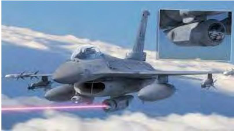
(図 11-5 F-16 戦闘機に搭載されたレーザー兵器(ロッキード・マーチン社))
