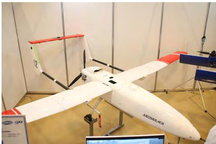
(図 8-7 チルト翼小型無人 VTOL 機「QTW VTOL UAV」<sup>293</sup>)
