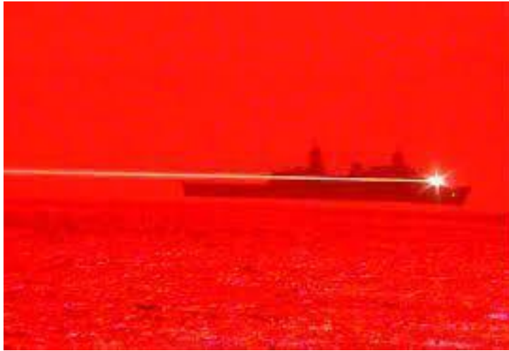
(図 11-4 USS Portland から照射される LWSD 369 )
