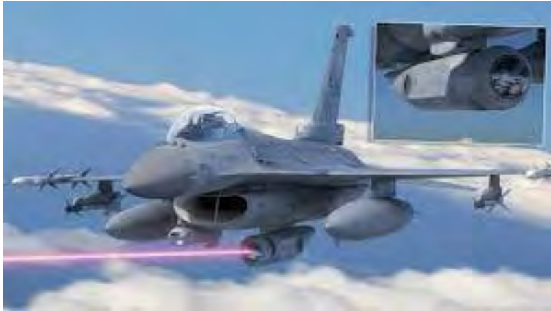
(図 11-5 F-16 戦闘機に搭載されたレーザー兵器(ロッキード・マーチン社))
