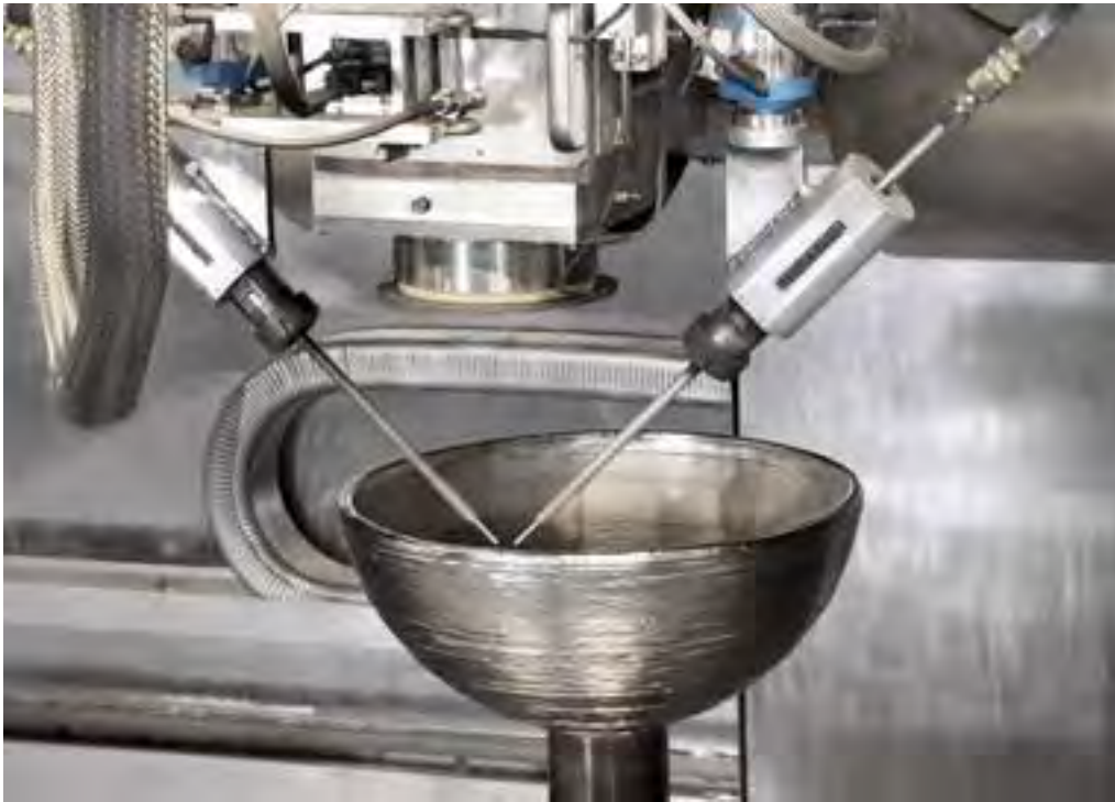
(図 11-15 Sciaky 社の EBAM 作業工程の様子 394 )
