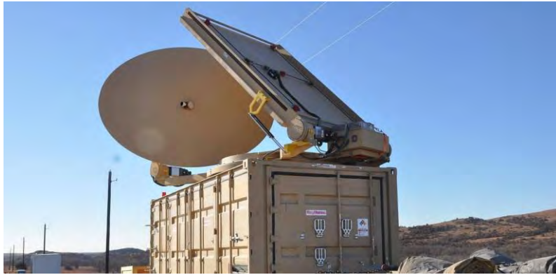
図 11-7 Phaser™ high-power microwave system (レイセオン・テクノロジーズ社) 374
