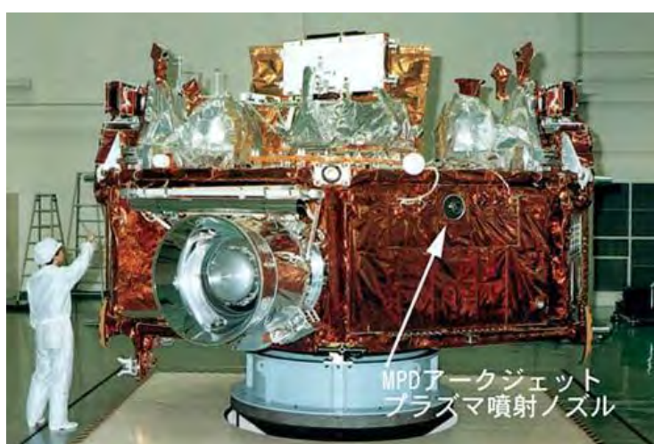
(図 18-8 MPD アークジェット。パワーはあるが、大電力が必要 715 )
