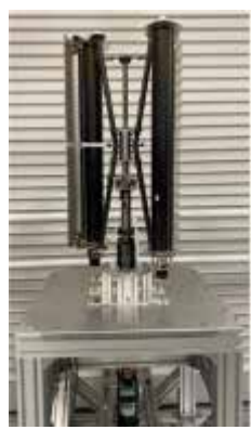
台風でも発電可能な 風力発電機 株式会社チャレナジー提供
