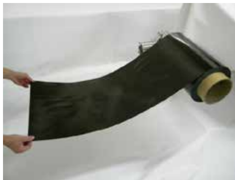
開発した熱可塑性薄層プリプレグシート
