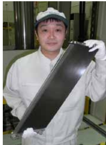
「PW1100G-JM」用の 複合材構造案内翼 (SGV) (IHI資料)
