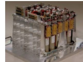
100Ah10直列リチウムイオンバッテリー組立
