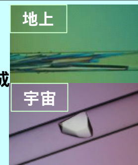
レーザー用半導体世界最長の均一組成単結晶
