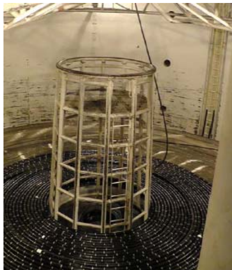
敷設船に積み込まれたケーブル
