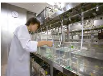
流水式曝露試験装置
