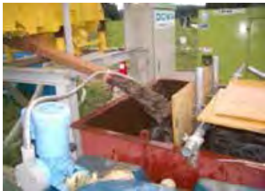
原泥水の流送（左）と混合槽での凝集剤添加（右）
