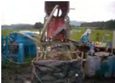
原泥水の流送（左）と混合槽での凝集剤添加（右）
