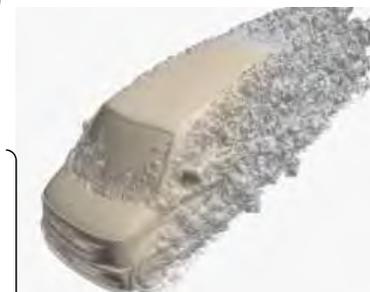
シミュレーションによる空気の流れ
