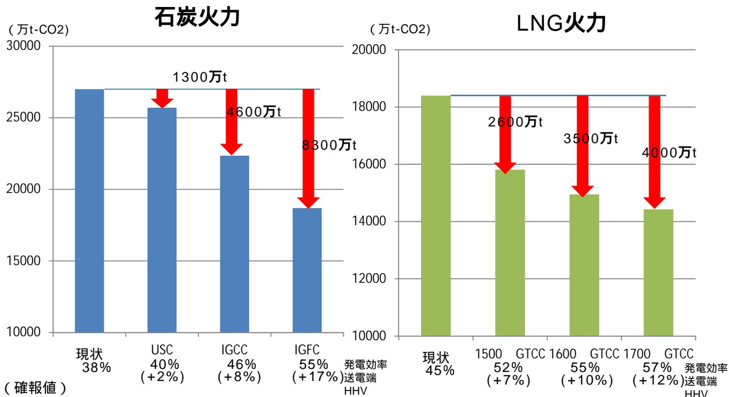
老朽化した石炭火力発電とは、50万kW（稼働率70%）の亜臨界圧微粉炭火力発電。老朽化したLNG火力発電とは、50万kW（稼働率70%）の汽力発電。
