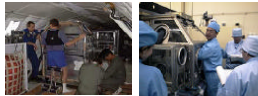
航空機実験による生命科学グローブボックスの形状の評価 (左)、並びに毛利宇宙飛行士による評価 (右)
