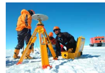
GPS測量機による観測
