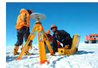
GPS測量機による観測
