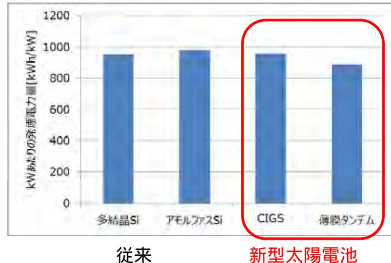
図2 太陽電池種別の平均kW当たりの発電電力量
