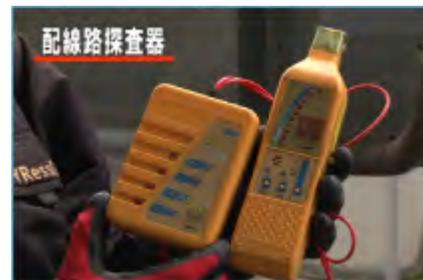
非接触の配線探査器による部分断線などを検知する方法
