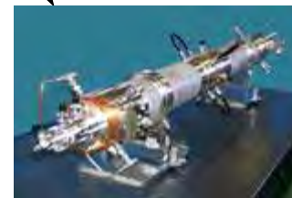
Cバンド線型加速器： 高加速勾配により、短い距離で高いエネルギーまで加速。
