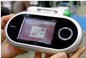
燃料電池利用PDA試作品 (約5時間の駆動が可能)
