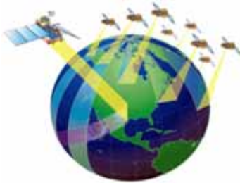
GPMイメージ図: 主衛星 に二周波降水レーダ搭載
