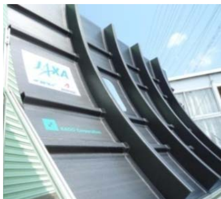
実機大模型による損傷許容試験
