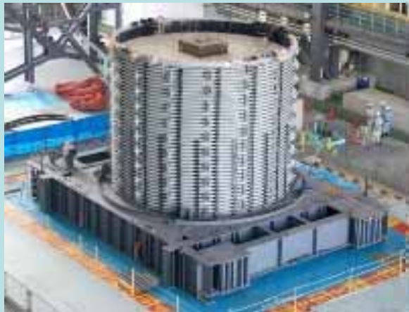
大規模振動台を用いた実証試験
