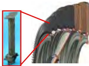
タービン翼への耐熱複合材 であるセラミックス基複合材の適用
