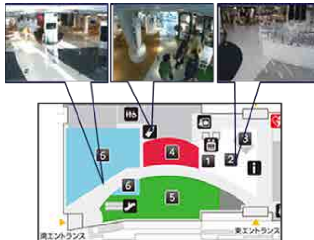
自律型モビリティシステムの動的電波環境の計測に必要な、固定カメラでの状況認識および予測技術を確立
