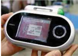
燃料電池利用PDA試作品 (約5時間の駆動が可能)
