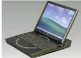
燃料電池一体型パソコン (動作時間は約10時間)
