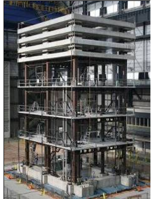
21階建て超高層建物を想定した実規模の試験体による震動台実験
