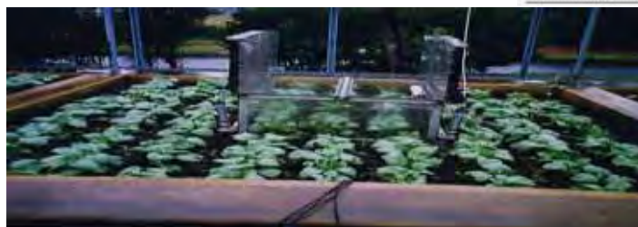
写真 農耕地からの温室効果ガス発生量の自動連続測定装置
