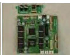
コグニティブ無線機用ハードウェアプラットフォーム、左:高周波部、中:FPGA信号処理部、右:CPU信号処理部
