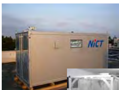
地上設置の 差分吸収ライ ダー外観とそ の内部
