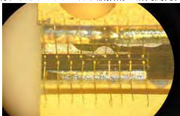
テラヘルツ帯量子カスケードレーザーの光学顕微鏡写真
