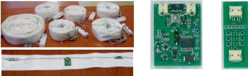
図3 試作された電子タグテープ
