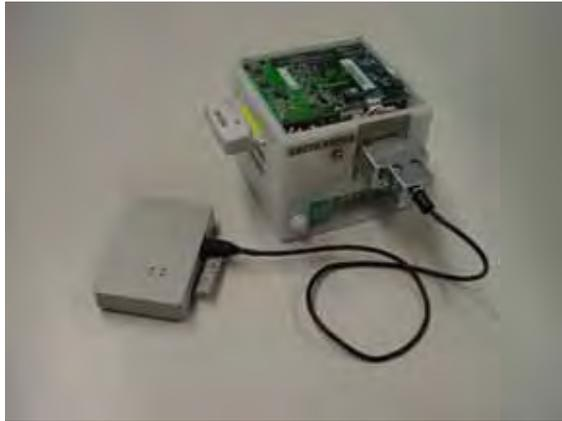
図9 データ中継ソフトウェアを実装したマイクロサーバとアクティブタグ
