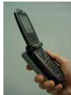
図 11 パッシブタグ、アクティブタグ、GPS による 3 ウェイ測位が可能な携帯電話端末
