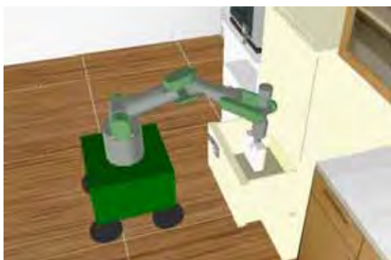
図8 アーム付き移動ロボットの作業シミュレーション
